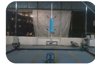
Platform I-Mangmoom หุ่นยนต์ 3 มิติ ในรูปแบบ Cable Robot
